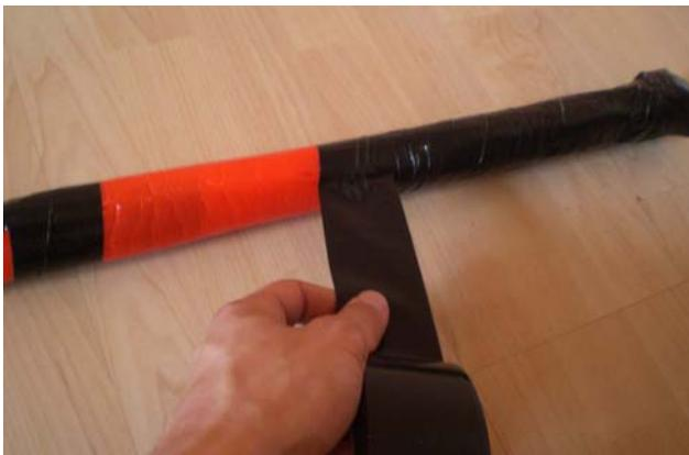
Umwickelt jetzt mit dem Klebeband das gepolsterte Plastikrohr, ohne dabei noch etwas vom roten Dämmmaterial frei zu lassen.
