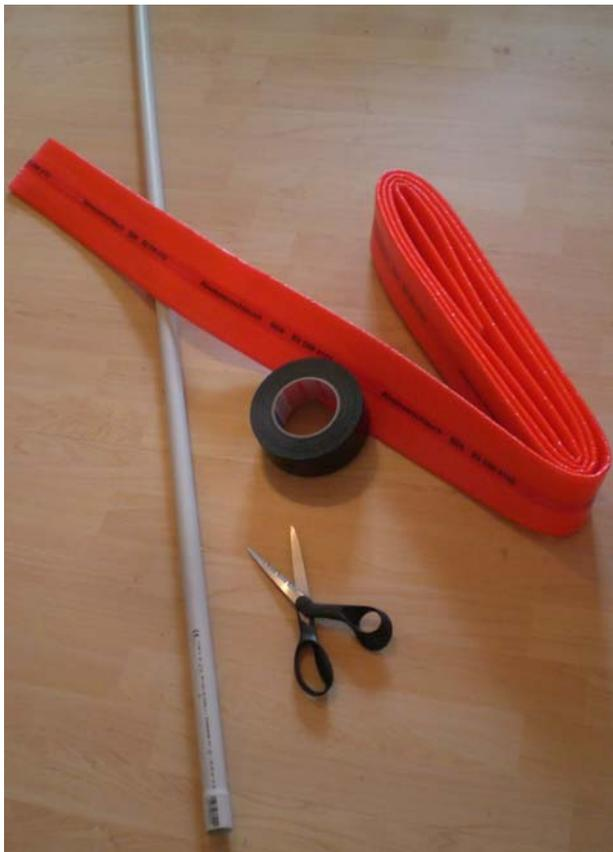
Als Ausgangsmaterial braucht ihr nur ein Plastikrohr (z. B. ein PVC-Stangenrohr mit 2,5 cm Durchmesser), etwas zum Polstern (z. B. „Abwasserschlauch 50/4 B2 DIN 4102“), und Textilklebeband oder so genanntes Panzerband.
